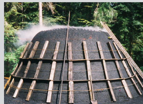
Aus dem brennenden Meiler tritt Wasserdampf aus.
