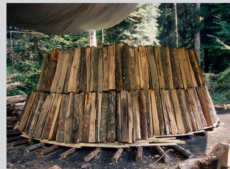
Der Bodenrost ist das Fundament des Meilers, in dessen Mitte der «Füllibaum» emporragt.
