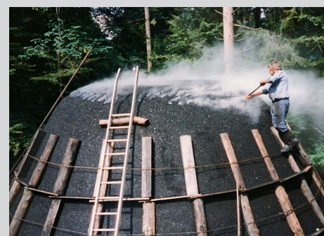
Der Köhler reguliert die Luftzufuhr durch Stechen von Luftlöchern.
